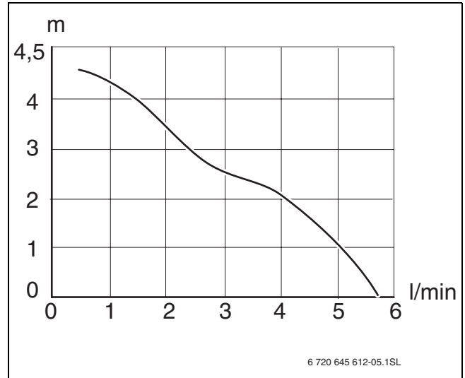
Şekil 3 Basma yüksekliğine (m) bağlı basma debisi (l/dk.)
